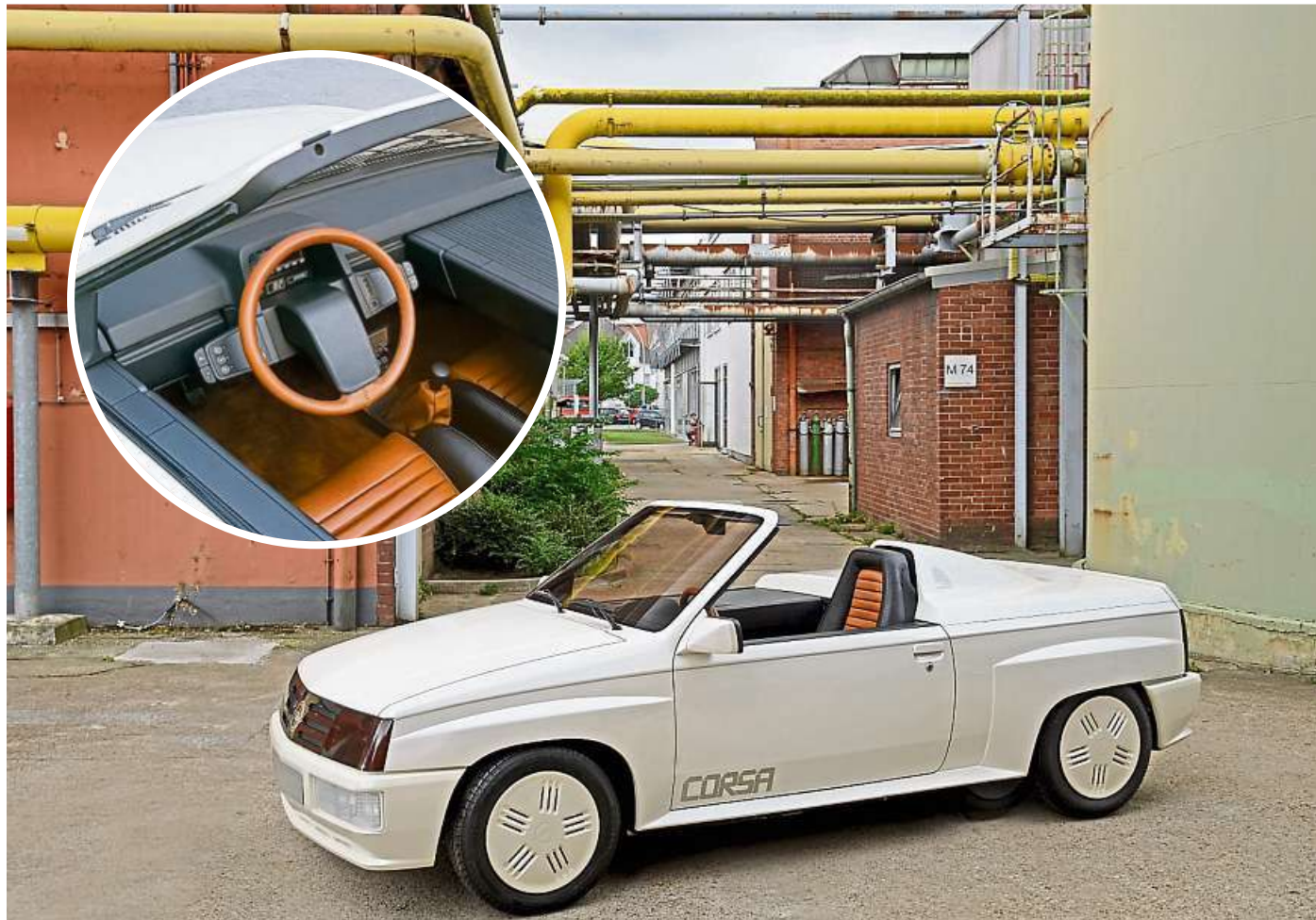
Das Modell der Opel-Studie Corsa Spider (1982) ist ohne Technik aus Fiberglas realisiert und manche seiner angedachten Funktionen nur angedeutet. Der Beifahrersitz kann mit einem Rollo im Beifahrersitz verdeckt werden. Die digitalen Bedienelemente (kleines Bild) können angeippt werden, ohne die Hände vom Lenker zu nehmen. Musik kommt aus dem Walkman, der sich an die Mittelkonsole und somit an die Lautsprecher in der Kopfstütze koppeln lässt.
